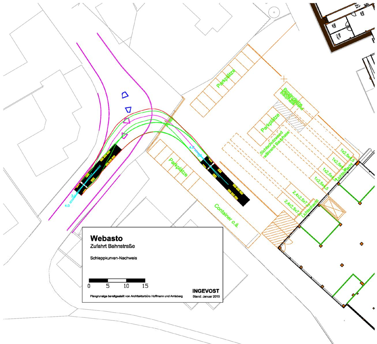
Um die Ein- und Ausfahrt in das WEBASTO-Firmengelände mit dem Bemessungsfahrzeug Sattelschlepper zu gewährleisten, muss die vorhandene Querungshilfe verschoben werden.
