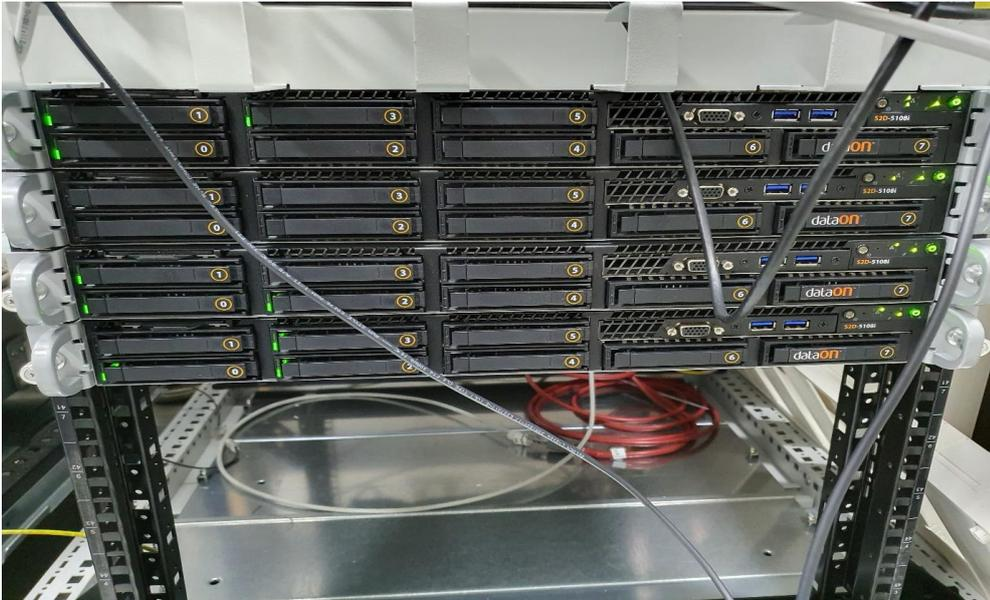
Bild B stellt einen kleinen Block unserer Infrastruktur dar. Da diese Geräte baugleich dem Bild A sind, wird deutlich, dass diese Server mittels 4 x 4 10 GB Schnittstellen an die Switches angeschlossen werden müssen, dies entspricht also 16 x 10 GB Ports an den Switches.
