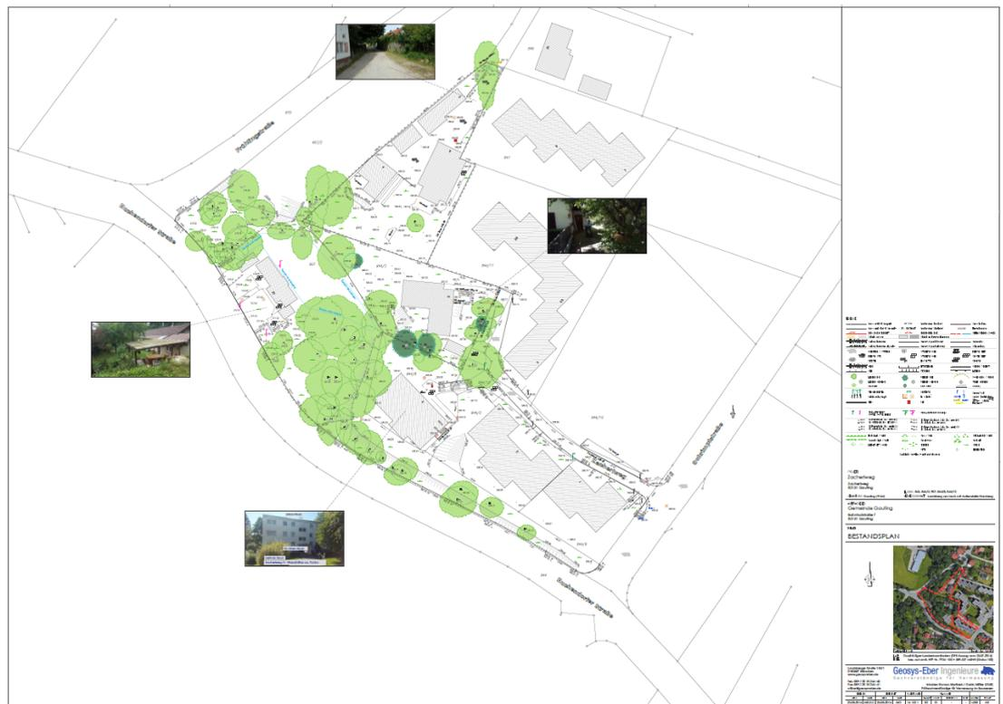
Abb. 2 Bestandsplan mit Höhen- und Baumaufmaß, Quelle: Ingenieurbüro Geosys-Eber
